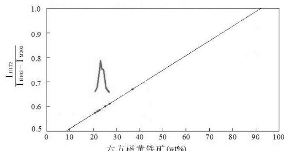
图 4 X 射线衍射强度系数与六方磁黄铁矿含量线性关系图<sup>[14]</sup>
