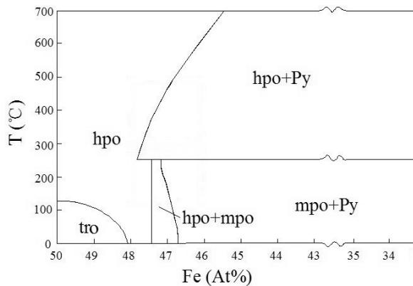
图5 Fe-S体系矿物相平衡简图<sup>[14]</sup>
