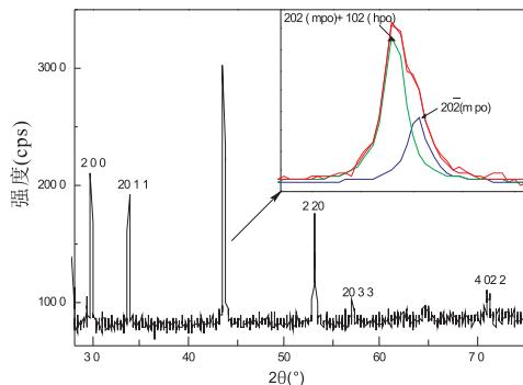
图 3 条带状矿石磁黄铁矿 X 射线粉晶衍射曲线
