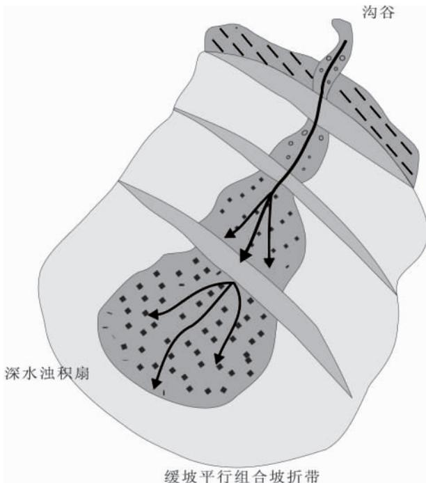
图5 缓坡平行状坡折带砂体控制示意图
