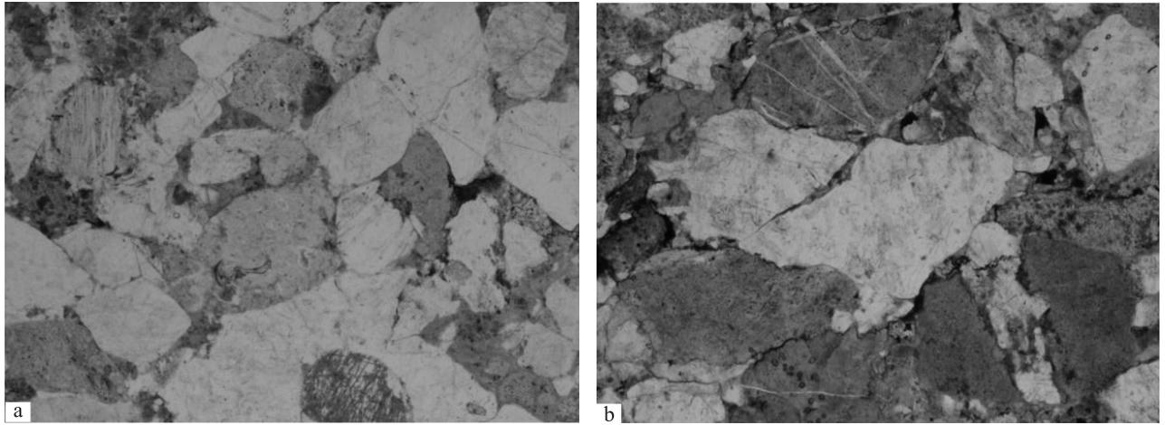
图5 柯柯亚构造中深层储层孔隙类型
