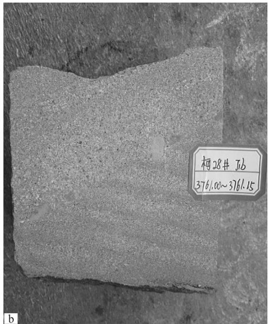
图2 柯柯亚构造八道湾组岩心照片
