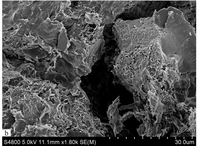
图 4 柯柯亚构造中深层储层粘土矿物
