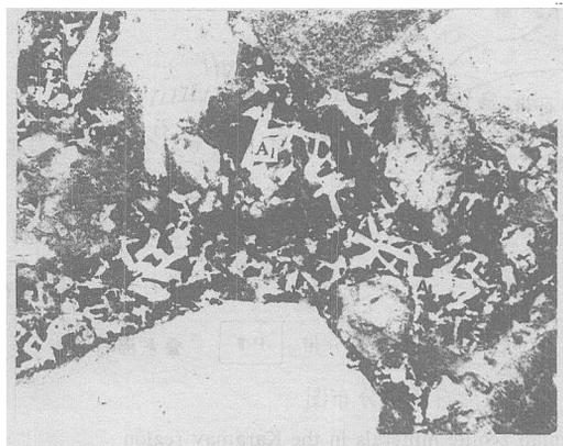
照片1 砂质砾岩,粒间孔由板条状钠长石(A1)充填,晶间孔隙发育(见沥青质充填)。(一)×64,检乌26井(深3360.25m处)
