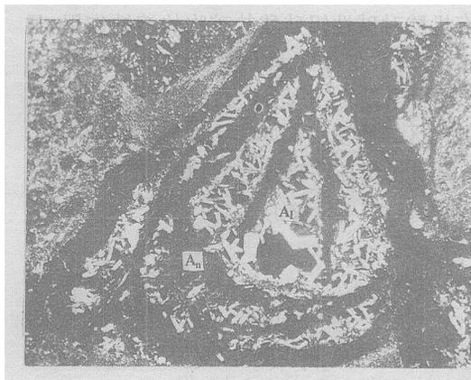
照片3 砾岩, 粒间孔隙中的连生晶体方沸石(An), 具环带状钠长石化(Al), 钠长石分布处尚见大量晶间孔。正偏光,  $\times 50$ , 检乌30井
