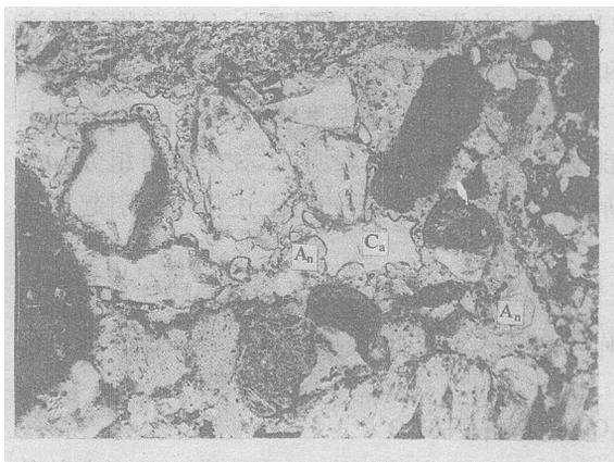
照片5 砂岩, 粒间孔隙中的方沸石(An)均被溶掉, 形成铸模孔, 而方解石(Ca)则无溶蚀现象。单偏光,  $\times 50$ , 8645井(深2650.50m)
